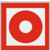
Кнопка включения установок (систем) пожарной автоматики
